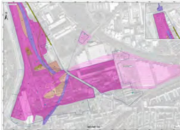
**Abbildung 46:** Übersicht der Ablagerungen/ Aufschüttungen
